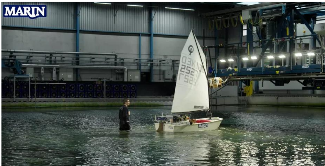
AI gestuurde Optimist als testplatform voor het aansturen van zeilende schepen.
